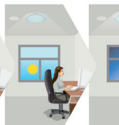
Image 3 à 6 : La lumière s'allumera au maximum ou effectuera une variation pour maintenir le niveau de lux demandé. La variation s'effectue en fonction du niveau d'apport de lumière naturelle.
