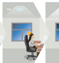
Image 3 à 6 : La lumière s'allumera au maximum ou effectuera une variation pour maintenir le niveau de lux demandé. La variation s'effectue en fonction du niveau d'apport de lumière naturelle.
