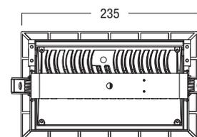
Corps en aluminium AL6063, finition blanc. Design rectangulaire unique et robuste, IP65, avec led COB haute efficacité, et driver isolé pour une meilleure dissipation thermique et une plus grande longévité du luminaire.
