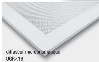
Cadre en aluminium extrudé, finition blanc RAL9016, dos en fer recouvert de zinc, grande rigidité. Guide lumière PMMA anti-jaunissement. Avec diffuseur opale (UGR<19) ou prismatique (UGR<16), effet glacé (UGR<16).
