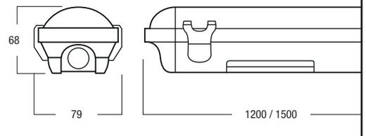
Corps et diffuseur en polycarbonate ultra résistant, IP65 et IK08, 3 connecteurs (central arrière et latéral), kit clips en inox inclus ...
